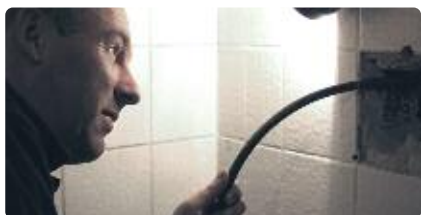
La gaine d'insertion du VISIO PRIME, facile à nettoyer et à désinfecter, offre une grande versatilité
