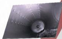
Réglage optique à l'infini, en DN 500 avec longue durée d'exposition.
